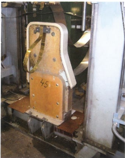
Bei der Herstellung des leichten Sessels 45 wird eine halbautomatische Presse verwendet.
